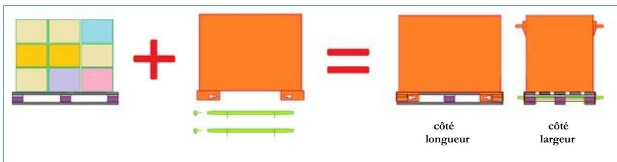
Ce conteneur ne pouvant excéder 200 Kg, un système de clipsage est prévu afin que des groupes de conteneurs puissent être manutentionnés par des engins plus conséquents tel que des transpalettes, des chariots élévateurs ou des grues.
